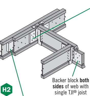
**DOUBLE TJJ® JOIST FILLER BLOCK**
